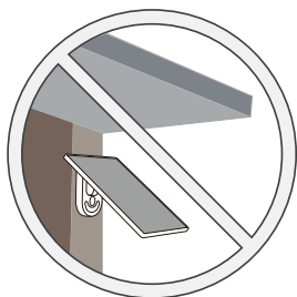
Unngå skygge fra bygningens takutstikk
